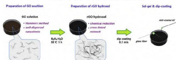
图 7 石墨烯涂覆 GF 溶胶-凝胶法和浸渍-涂覆法的制备原理图 [34]
